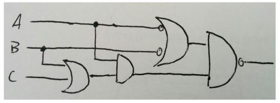
((A'+B')(B+C)A)' ((A'(B+C) + B'(B+C))A)' (A'(B+C)A + B'(B+C)A)' (AA'(B+C) + B'(B+C)A)' (B'(B+C)A)' (B'BA + B'CA)' (B'CA)' (AB'C)'
